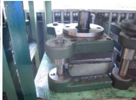
Die for end-plate rim-bending
